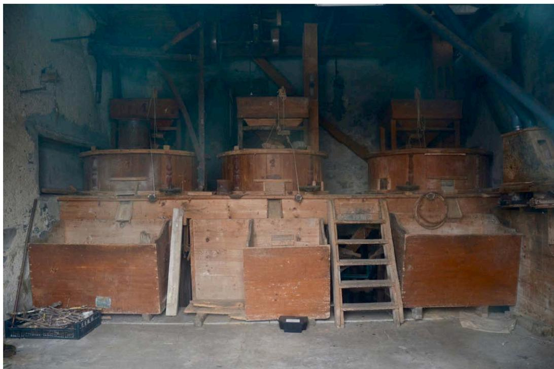
Tre coppie di macine in un mulino a ruota verticale (Mulino a Monti di Bedonia).
